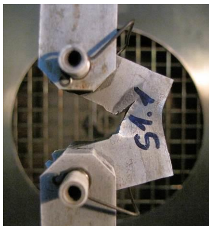
Rys. 3.19. Rozrywanie próbki w komorze temperaturowej w -10^{\circ}\text{C} , faza rozwoju pęknięcia dominującego
