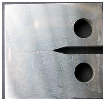
Rys. 3.9. Próbką kompaktowa z wypropagowaną szczeliną zmęczeniową o konkretnie zadanej długości
