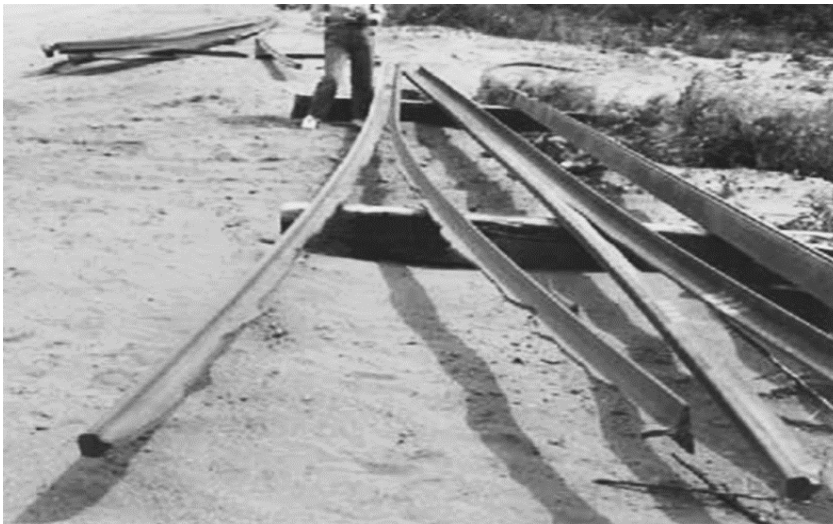
Rys. 1. Skutki bardzo wysokich naprężeń własnych w szynach kolejowych (z Understanding Stresses in Rails (Part 2) , January 4, 2014 / Filed under: Rail Maintenance, Jude Igwemezie, • April, 2007)
