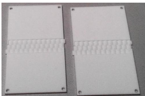
Rys. 6. Macierze soczewek wykonane metodą druku 3D
