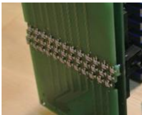
Rys. 5. Pojedynczy panel 3 x 12 detektorów
