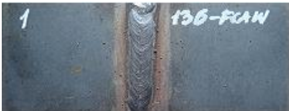
Rys. 4. Połączenie spawane wykonane metodą MAG
