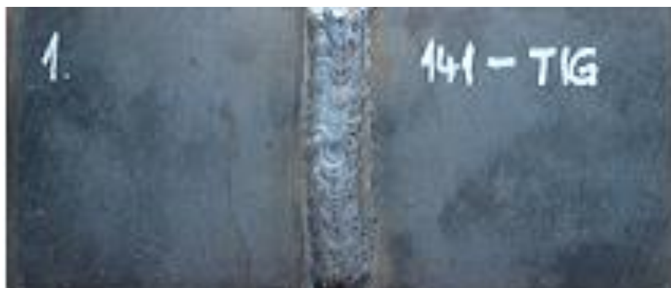
Rys. 5. Połączenie spawane wykonane metodą TIG
