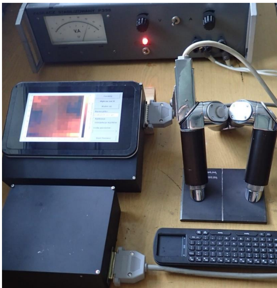
Rys. 11. Zestaw pomiarowy używany do aktywnych badań magnetycznych
